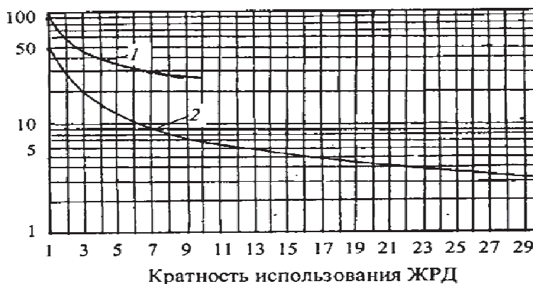
Рисунок 2 – Влияние кратности использования и размерности двигателя на затраты
