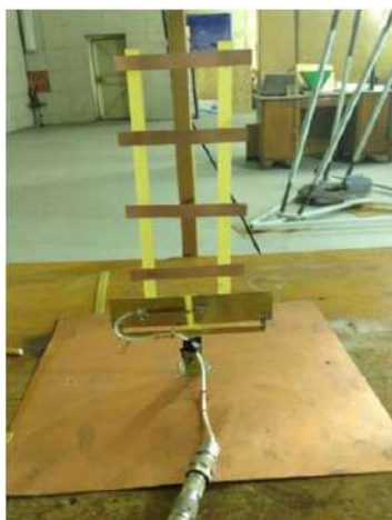
Рисунок 2 – Фотография лабораторного макета волнового канала ДI, ДII для одной поляризации
