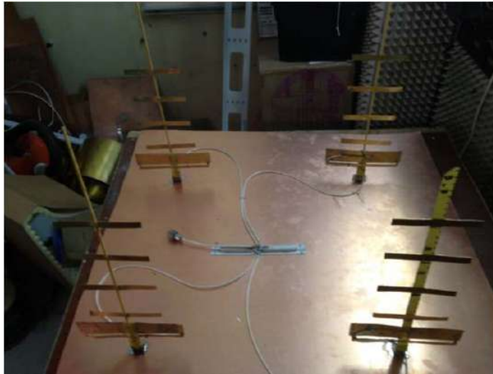
Рисунок 16 – Фотография лабораторного макета синфазной антенной решетки на базе волнового канала
