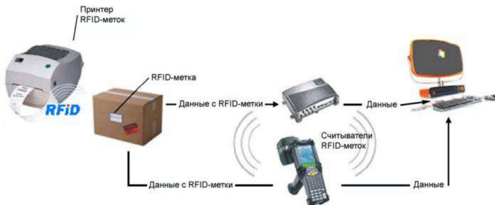
Рисунок 5 – Система идентификации объектов RFID
