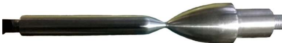
Рисунок 3 – Формообразующая оснастка для изготовления заготовки КС
