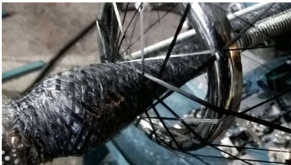
Рисунок 4 – Процесс создания углеродного каркаса КС
