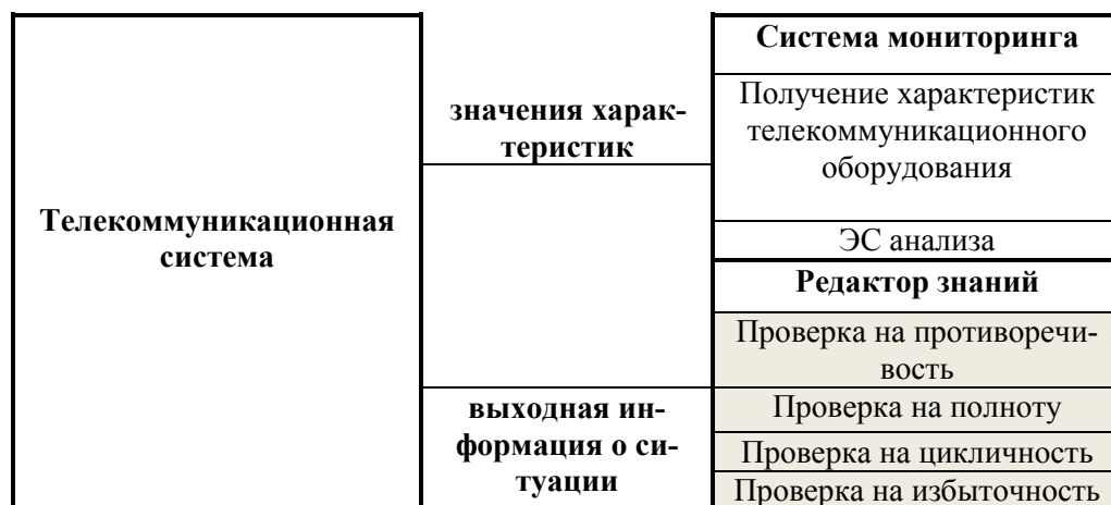
Рисунок 5 – Типовая структурная схема взаимодействия редактора знаний с системой мониторинга телекоммуникаций
