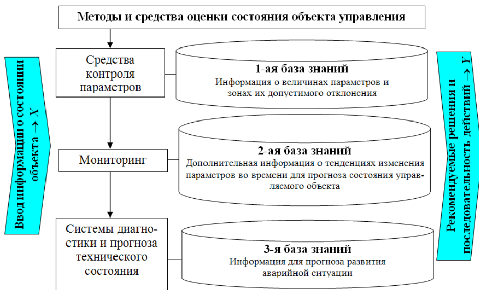
Рисунок 1 – Структуризация контролируемых объектов при оценке их состояния
