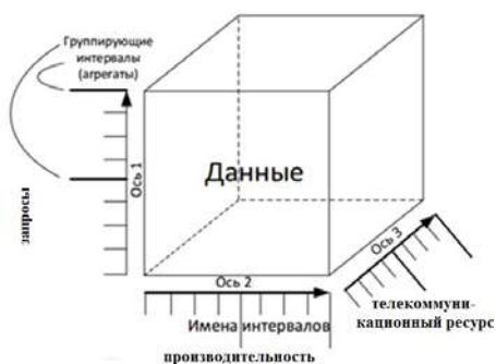
Рисунок 4 – Типовая структура многомерного куба для хранения и обработки данных о состоянии телекоммуникационной системы
