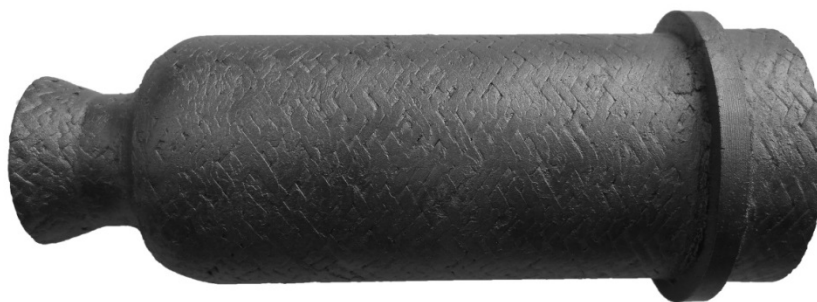
Рисунок 5 – Камера сгорания жидкостного ракетного двигателя малой тяги из углерод-керамического композиционного материала с переходным кольцом из углерод-керамического композиционного материала типа «Ипресскон»
