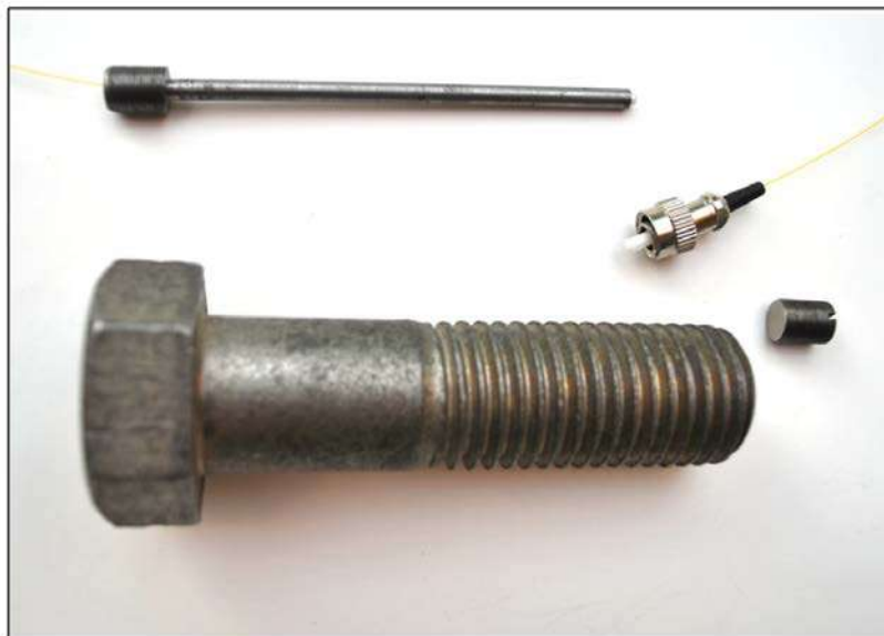
Рисунок 5 – Пример исполнения крепёжного устройства с ВОД для измерения деформации
