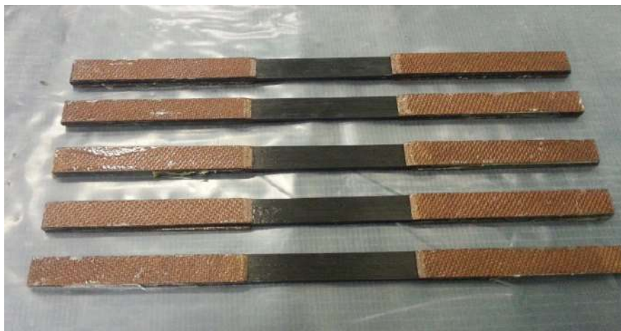
Рисунок 1 – Образцы высокотеплопроводного углепластика на основе углеродного волокна из пека и дисперсно-модифицированной матрицы ЭНФБ для проведения испытаний на растяжение
