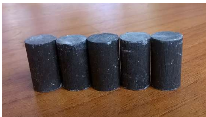
Рисунок 2 – Образцы высокотеплопроводного углепластика на основе углеродного волокна из пека и дисперсно-модифицированной матрицы ЭНФБ для определения продольного коэффициента теплопроводности
