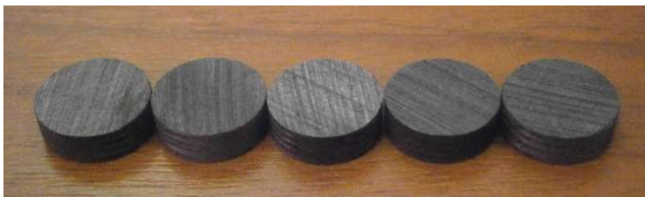
Рисунок 3 – Образцы высокотеплопроводного углепластика на основе углеродного волокна из пека и дисперсно-модифицированной матрицы ЭНФБ для определения поперечного коэффициента теплопроводности
