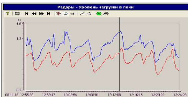
Рисунок 2 – Уровень засыпи в контрольных точках доменной печи № 10 «ММК»
