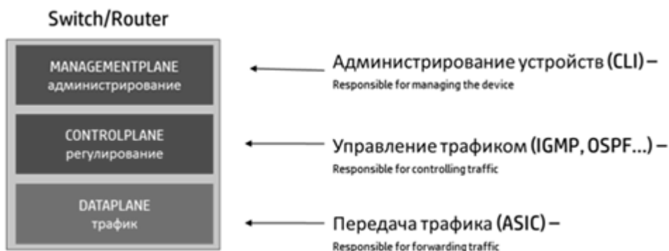
Рисунок 5 – Компоненты современных сетевых устройств SDN
