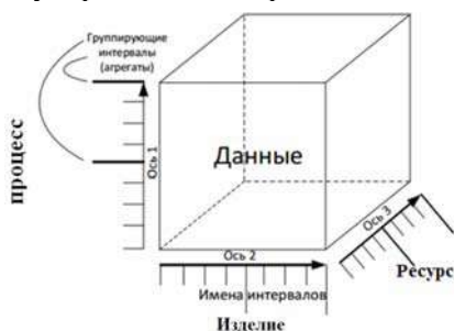
Рисунок 2 – OLAP-куб с измерениями «Изделие – Процесс – Ресурс»
