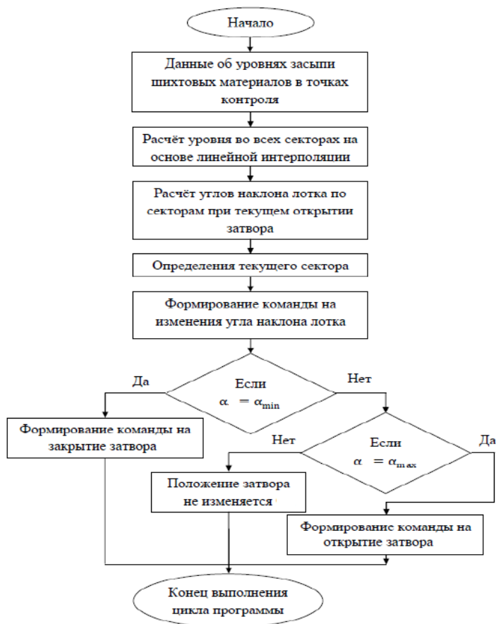
Рисунок 8 – Блок-схема алгоритма управления углом наклона и положением затвора: \alpha , \alpha_{\min} , \alpha_{\max} - текущий, минимальный и максимальный угол наклона лотка
