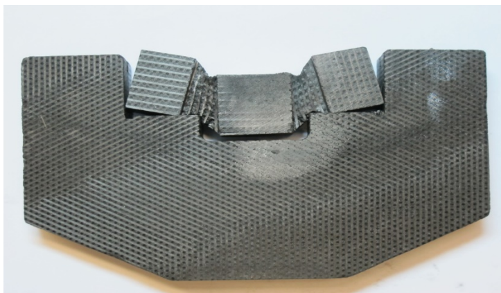
Рисунок 4 – Фотография образца второго типа, испытанного при температуре T \geq 2200 °С
