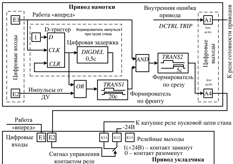
Рисунок 2 - Функциональная схема системы защиты от остановки укладчика
