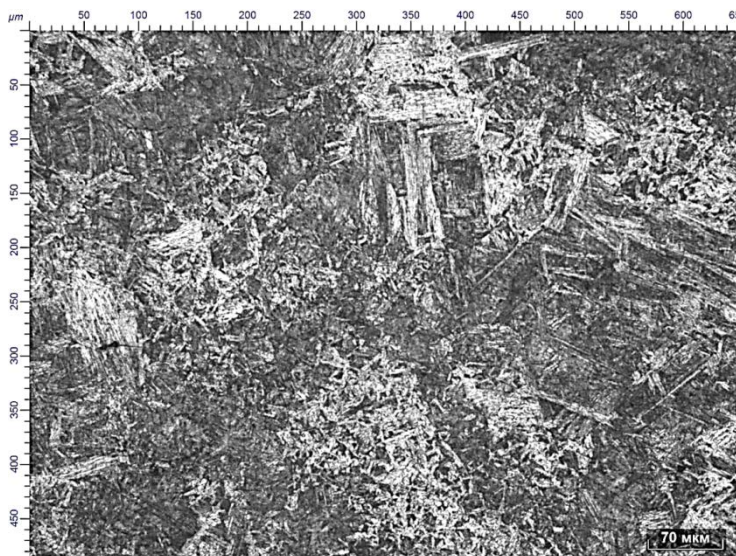
Рисунок 6 – Микроструктура отдельно отлитого образца из стали 35ХГСЛ после предварительной термической обработки
